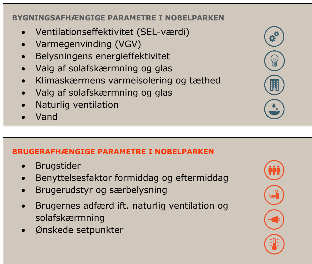
Figur 3 Udvalgte parametre for Nobelparken blev i energioptimeringen i BeReal opdelt i to overordnede grupper.
