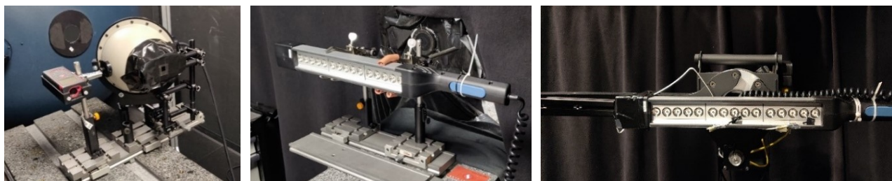
Figur 12 Fotos af måleopstilling for Purizap, monteret på optisk bænk (midt) og integrerende kugle og astandsmåler (venstre) og monteret af Purizap i goniospektrometerradiometer (højre).
