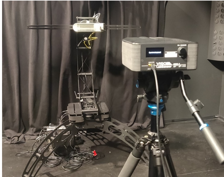
Figur 2 Foto af LabSpion goniospektrometerradiometer hvor UVC-rør i armatur er monteret og hvor UV-VIS sensoren er placeret 2.5 m fra rotationscentret for LabSpion.
