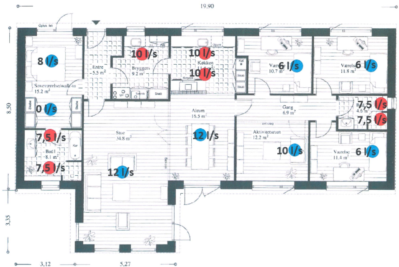
Figur 10: Arealfordelt ventilation med 0,3 \text{ l/s} pr. opvarmet etageareal i forhold til styringen 'Normal'. Indblæsning er markeret med blå. Udsugning er markeret med rød. Markeringerne er ikke placeret hvor armaturerne skal sidde
