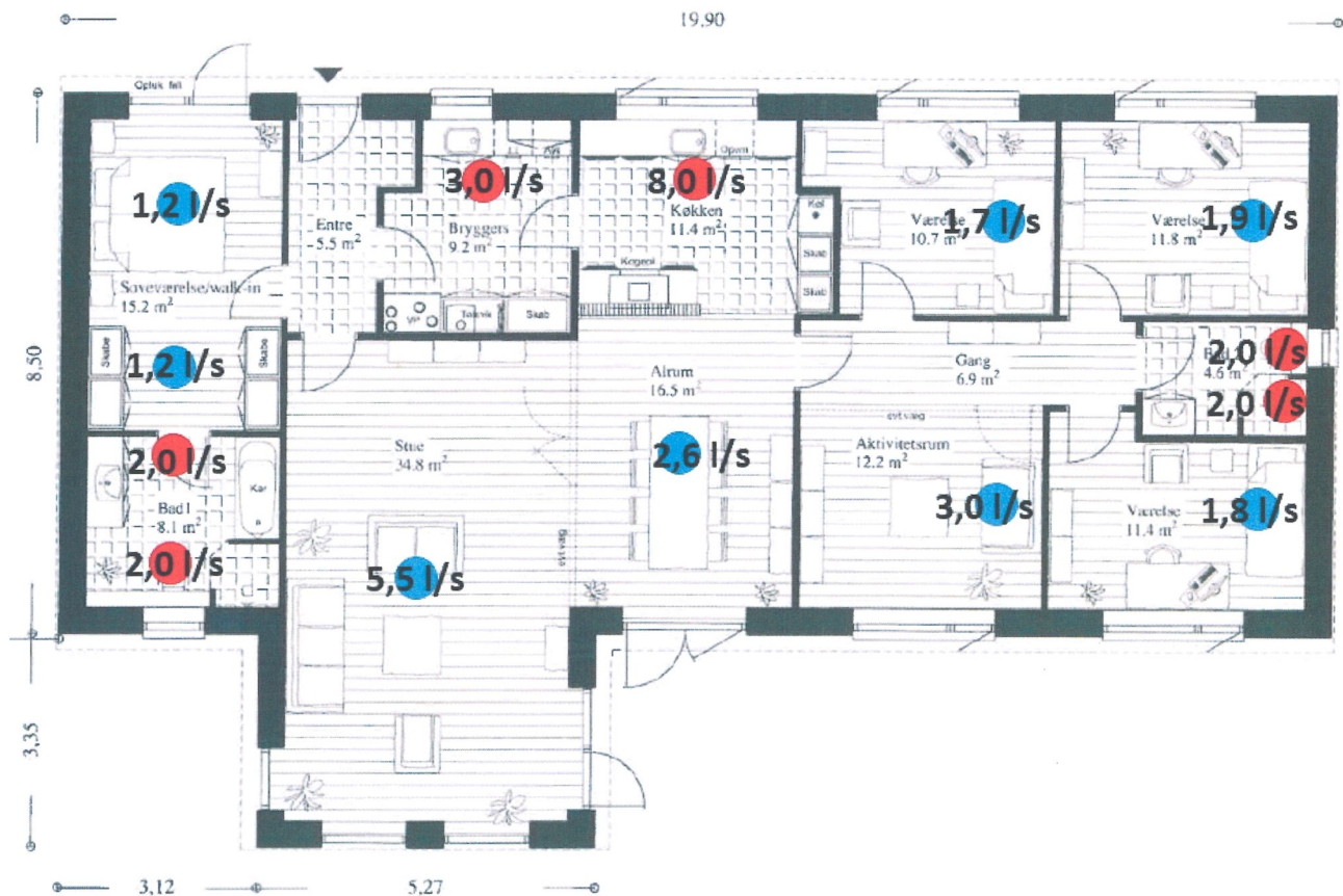
Figur 7: Eksempel på arealfordelt ventilation med 0,1 l/s pr. opvarmet etageareal. Indblæsning er markeret med blå. Udsugning er markeret med rød. Markeringerne er ikke placeret hvor armaturerne skal sidde
